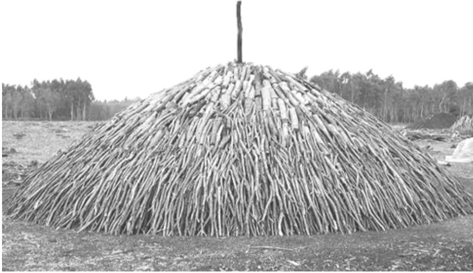
Resim: 1- Basit (Dik) Torluk için Odunların İstiflenmesi Photo : 1- Arrangement of Wood in the Simple Kiln
